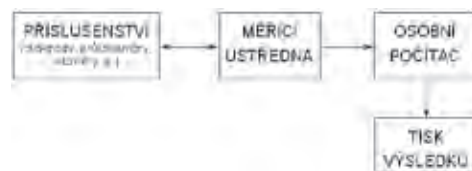
Obrázek 1: Schéma pracovní jednotky BIOPAC
